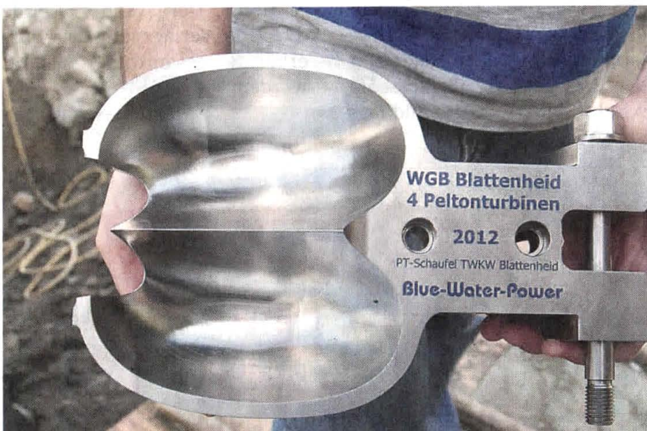
21 Schaufelräder dieser Grösse sind am Turbinenrad angebracht. Dieses
