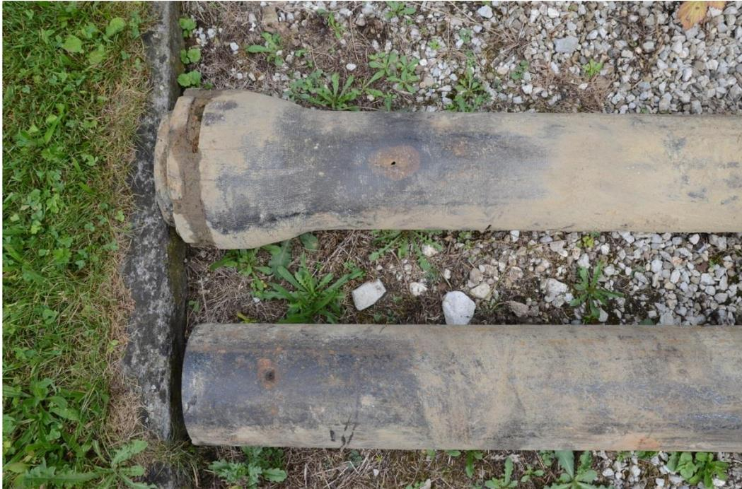
Duktile Gussrohre geschraubt mit deutlichen Lochfrassspuren.
