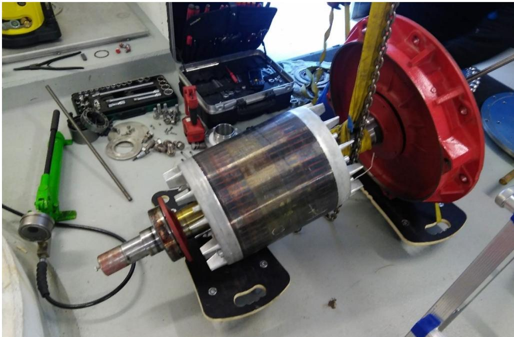
*Lagerwechsel beim Generator KW Oberstocken*
