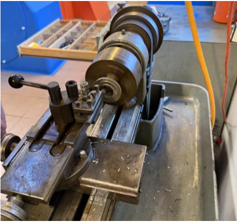
Der Dichtsitz wurde fachgerecht abgedreht
