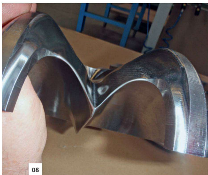
08 Kavitationsspuren an der Oberseite des Bechers, vor der Änderung des Profils. Traces de cavitation à l'extrados de l'auget avant la modification de son profil.
